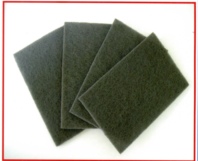
◇ウルトラファイン【B-1200】 粒度 #1200相当 色 グレー サイズ:230×150mm 梱包 :10枚入り/1箱
