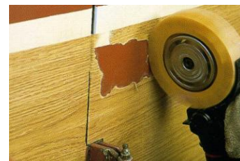
厚いステッカーの剥離
