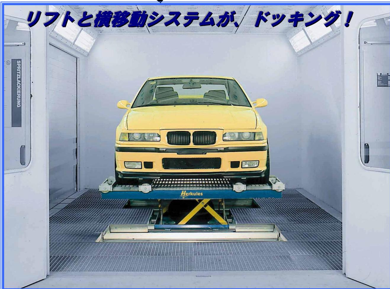
リフトにトラバースレールが設置されているため、トラバース台車に乗ったままリフトアップが可能な上、リフトの上をトラバースが通過できるドライブオーバーシステム
