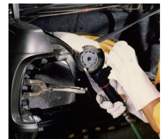
溶接表面の部分出しに
