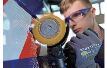
厚いステッカー剥離
